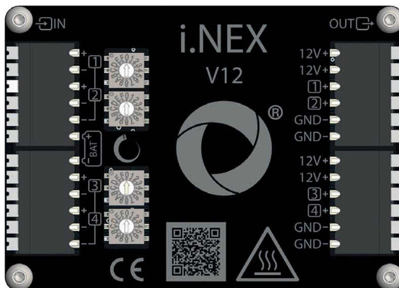
Das **i.NEX** verfügt über 4 Blöcke mit insgesamt 24 Klemmanschlüssen:
