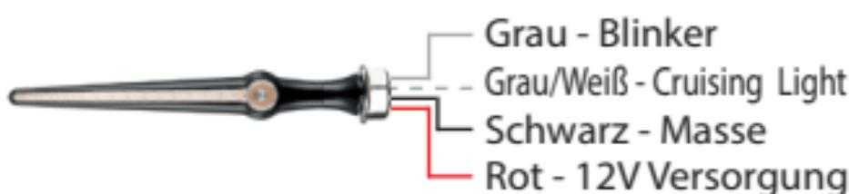
Verlegen Sie die Kabel so, dass sie vor Spritzwasser geschützt sind und befestigen Sie sie in geeigneter Weise, z. B. mit Kabelbindern. Testen Sie die Funktion der Jetstream® CL an Ihrem Fahrzeug.
