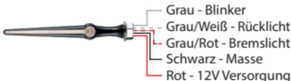
Verlegen Sie die Kabel so, dass sie vor Spritzwasser geschützt sind und befestigen Sie sie in geeigneter Weise, z. B. mit Kabelbindern. Testen Sie die Funktion der Jetstream® DF an Ihrem Fahrzeug. Der Umbau ist damit abgeschlossen.
