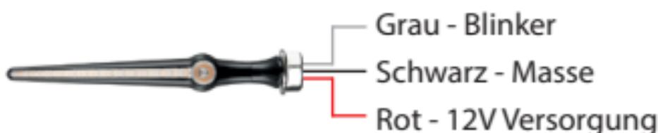
Verlegen Sie die Kabel so, dass sie vor Spritzwasser geschützt sind und befestigen Sie sie in geeigneter Weise, z. B. mit Kabelbindern. Testen Sie die Funktion der Jetstream® an Ihrem Fahrzeug.
